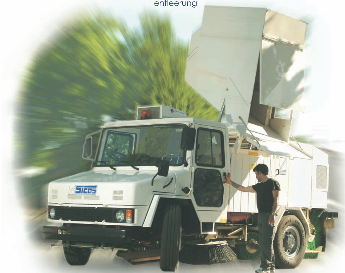
Edelstahlbehälter mit 2.200 mm Hochentleerung
