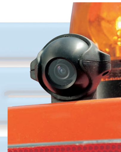
Rückblickkamera für erhöhte Arbeitssicherheit
